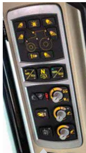
Nurgapostile paigaldatud JVV kiirusvaliku ja rippüsteemi juhtlülid
